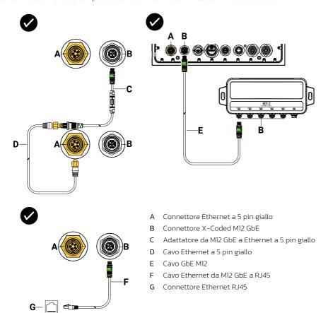
**Non** utilizzare più di un adattatore da X-Coded M12 GbE a Ethernet a 5 pin giallo quando si collegano i dispositivi.
