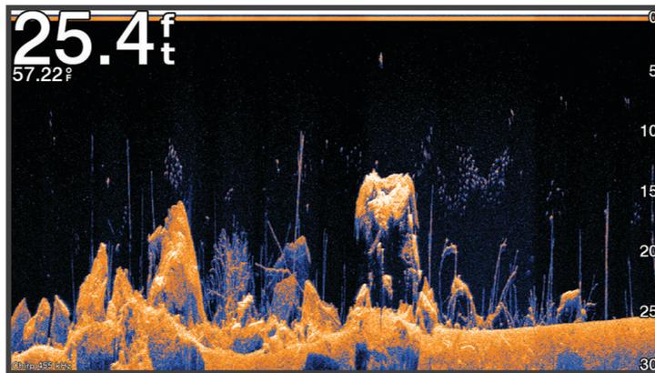
I trasduttori tradizionali emettono un fascio conico. Il sonar Garmin ClearVü che scandisce il fondale emette un fascio simile alla forma del fascio in una fotocopiatrice. Questo fascio fornisce un'immagine più nitida e verosimile di quanto è presente sotto l'imbarcazione.
