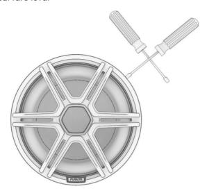
**NOTA:** per risultati ottimali, evitare di posizionare lo strumento di leva al centro di una linguetta di fissaggio. La griglia è più facile da rimuovere quando si inizia da uno dei bordi di una linguetta di fissaggio.
