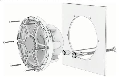
18 Fissare l'altoparlante alla superficie di installazione utilizzando le viti in dotazione.
