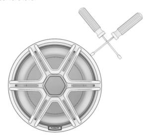
**NOTA:** per risultati ottimali, evitare di posizionare lo strumento di leva al centro di una linguetta di fissaggio. La griglia è più facile da rimuovere quando si inizia da uno dei bordi di una linguetta di fissaggio.
